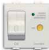
2CSK1307CH Interruttore automatico magnetotermico differenziale, 1P+N, C6 - 10mA, potere di interruzione 1,5kA
