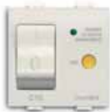
2CSK1308CH Interruttore automatico magnetotermico differenziale, 1P+N, C10 - 10mA, potere di interruzione 3kA
